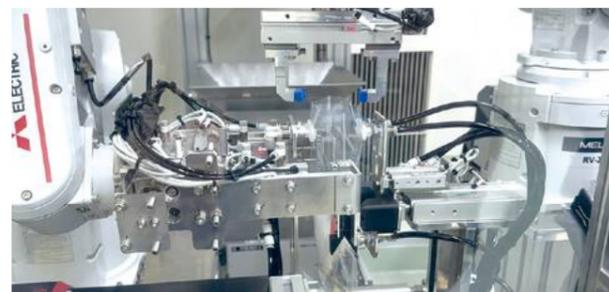
ロボットが包装用ポリ袋を開いて製品を入れます。柔らかいポリ袋に対応するため、専用のロボットハンドを設計しました。
