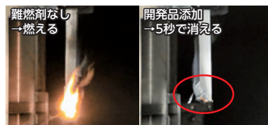
▲ポリカABSの難燃性試験 (UL-94V試験)
