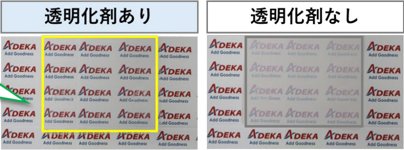
写真左：ポリプロピレンにトランスパレックスを 0.1%添加した試験片（厚み1mm）
