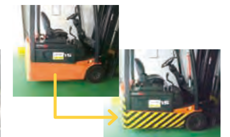
フォークリフトに反射テープを貼付、速度を制限して夜間作業の視認性を向上
