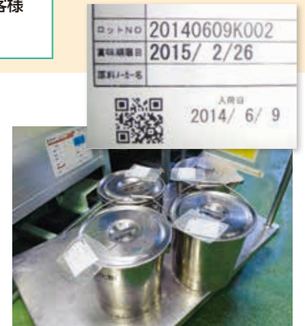
QRコードによる管理 全ての原料にQRコードが付いたラベルを貼付。原料受入、製造、出荷を通して、QRコードを活用したトレーサビリティシステムで管理しています
